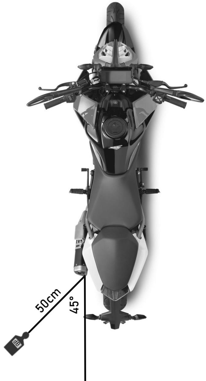
Das Messgerät wird auf Höhe der Auspuffmündung, im Winkel von 45° zur Fahrtrichtung und im Abstand von 50cm positioniert. Der Motor wird auf die halbe Nenndrehzahl gebracht, nach 3 Messungen ist der Durchschnittswert maßgeblich.
